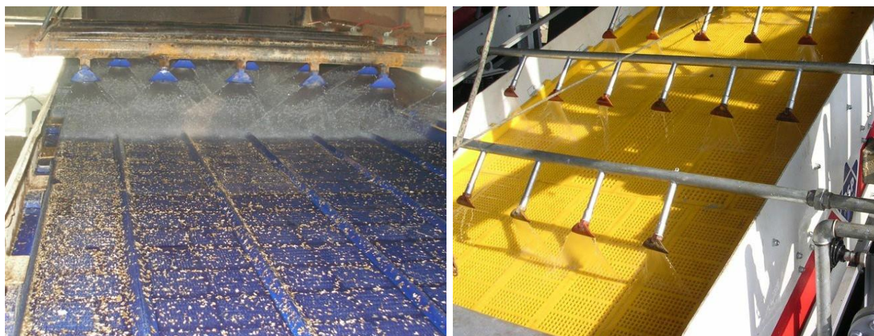
Рис.2 Работа форсунок в составе виброгрохота
